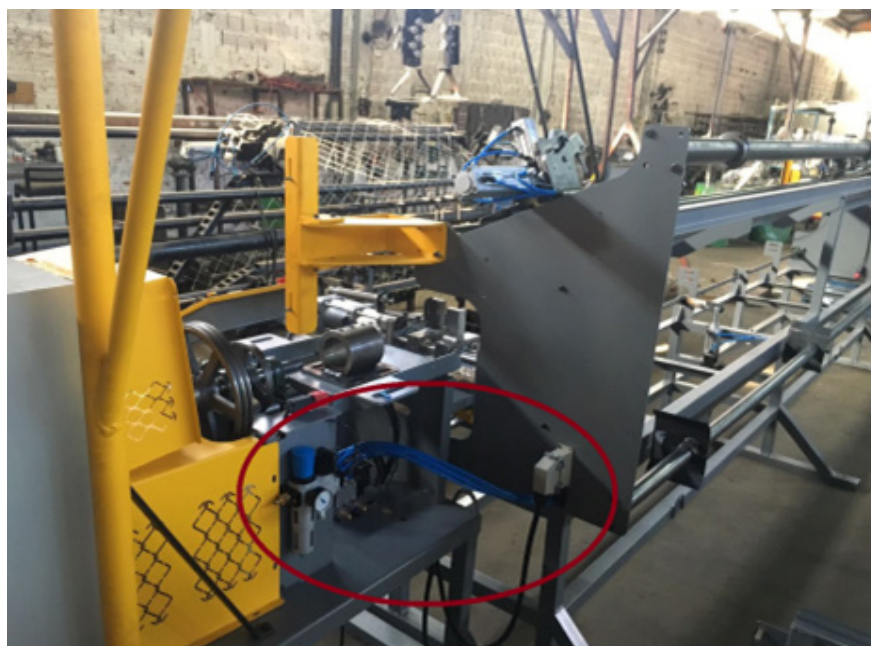
Figura 2 – Zona de risco 3 onde apresenta em destaque a região que contém parte do sistema pneumático.
