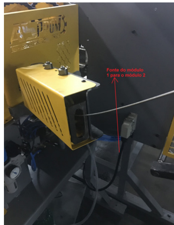
Fig 46 - Ilustração da fonte do módulo 2 conectada através do cabo fonte no painel do módulo 1.
