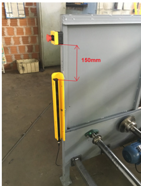
Fig 41 - posição da cortina de luz do módulo 3 (atrás do bobinador de tela), esta deve estar distante 150mm do botão de parada de emergência no sentido vertical. O par do sensor, fixado no lado oposto do vão do módulo, deve ser posicionado de forma alinhada ao mesmo plano da representada na foto.
