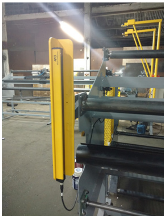
Fig 42 - Posição da cortina de luz do par fixado no módulo 2.
