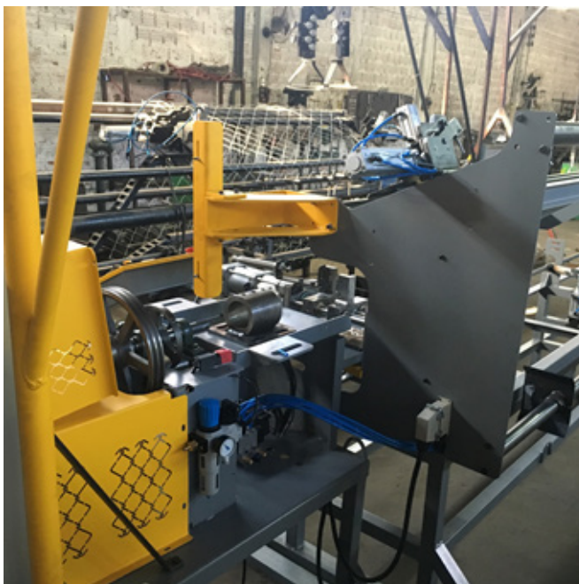
Fig 45 - Ilustração dos cabos conectados no módulo 1 e seguindo sua passagem na estrutura do módulo 2, onde sobe pela canaleta (atrás da chapa cinza na imagem) até o conector no punção pneumático.
