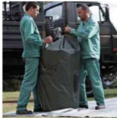
Dobrar o reservatório a 1/3 pelo comprimento e enrolá-lo totalmente.
