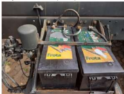
Figura 4.4: Suporte de fixação das baterias sem porcas nos parafusos
