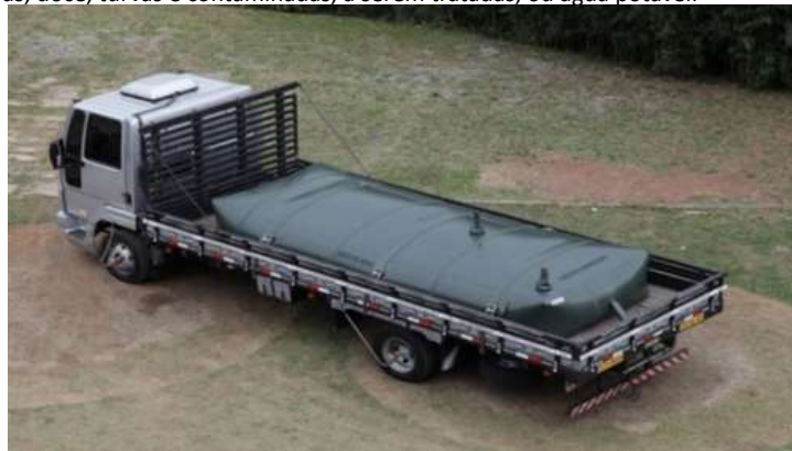
Figura 6.1: Reservatórios flexíveis para água instalados nas carrocerias de viaturas.
