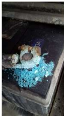
Figura 4.2: Bateria de viatura de engenharia do EB com zinabre
