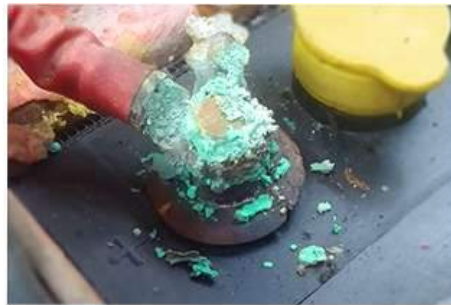
Figura 4.1: Polo da bateria e conector do cabo com zinabre
