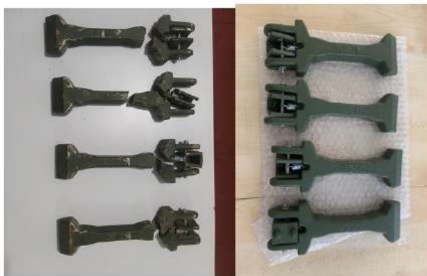
Figura 8.2: Peça danificada e nova
