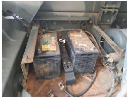
Figura 4.5: Baterias sem suportes de fixação e sem tampa de proteção
