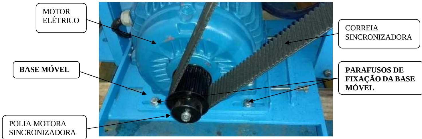
Foto lado sujo: Sistema de esticamento/afrouxamento das correias
