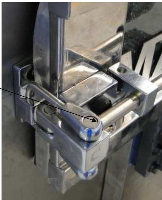
(Foto: trava com regulagem de fechamento da porta)
