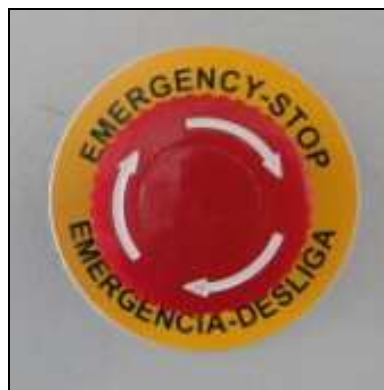
Foto: Botão de emergência
