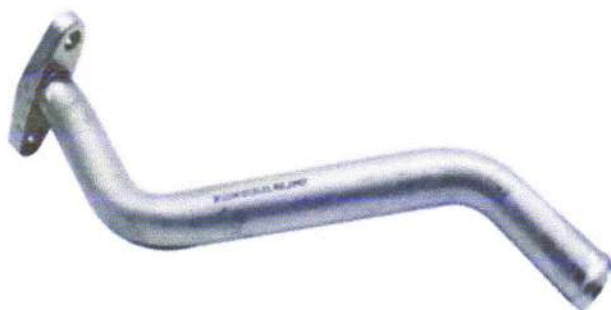
Tubulação de oleo do retorno do turbo compressor (turbina) Modelo MWM 6.10 TCA
