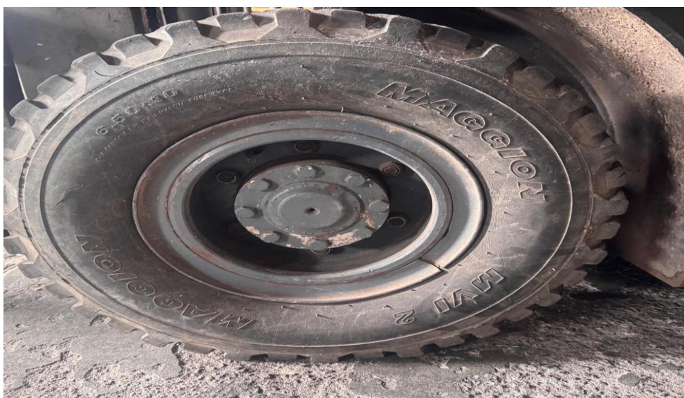
Foto do Pneu dianteiro esquerdo completamente desgastado
