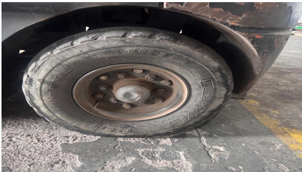
Foto do Pneu traseiro esquerdo completamente desgastado
